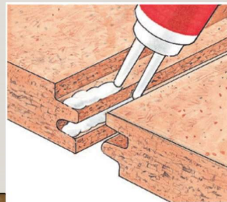
Figur 17 Undergulvsplader limes altid i fer og not - eller på begge sider af feren - før samling af pladerne.
