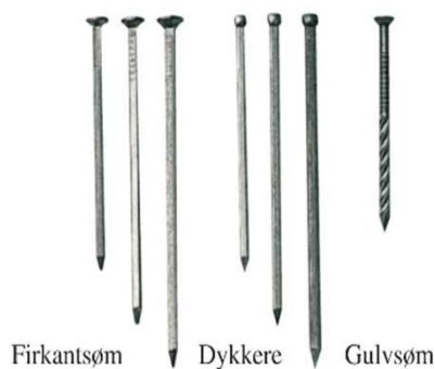
Figur 23 Sømtyper til håndsømning. Gulvsøm anvendes især ved udbedring af eksisterende gulve.
