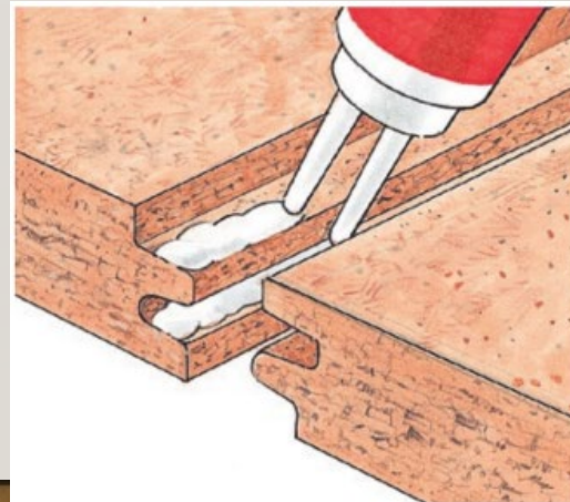
Figur 17 Undergulvsplader limes altid i fer og not - eller på begge sider af feren - før samling af pladerne.
