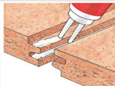
Figur 17 Undergulvsplader limes altid i fer og not – eller på begge sider af feren – for samling af pladerne.
