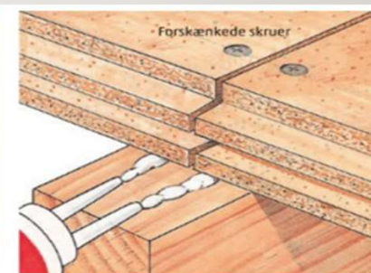
Figur 18 Undergulvsplader limes og skrues altid til bjælker og strøer. Frie kanter skal altid understøttes.
