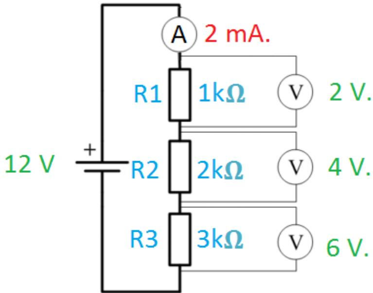
I en serieforbindelse er den samlede modstand ( $R_{Total}$ ) summen af alle modstandene lagt sammen, i dette eksempel:  $(R_1 + R_2 + R_3 = R_{Total})$   $1000\Omega + 2000\Omega + 3000\Omega = 6000\Omega$
