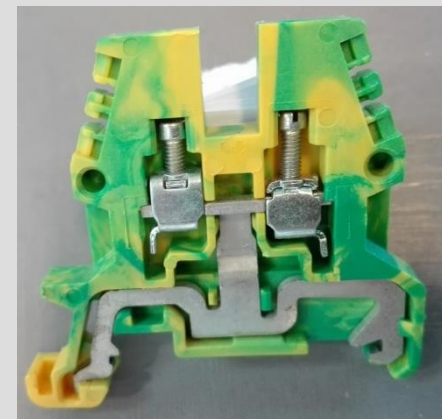
Rækkeklemme for beskyttelses- og udligningsforbindelse. Bemærk at klemmen også får forbindelse på den metalskinne som den monteres på.
