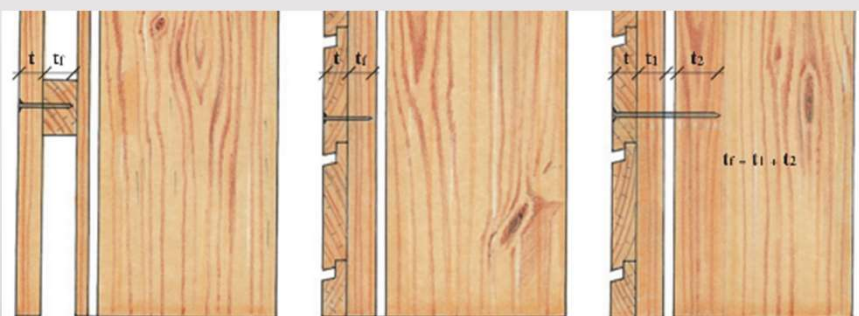
Figur 80 Fastgørelsesprincipper for søm og skruer afhængig af den valgte søm- eller skrue type, se tabel 7.
