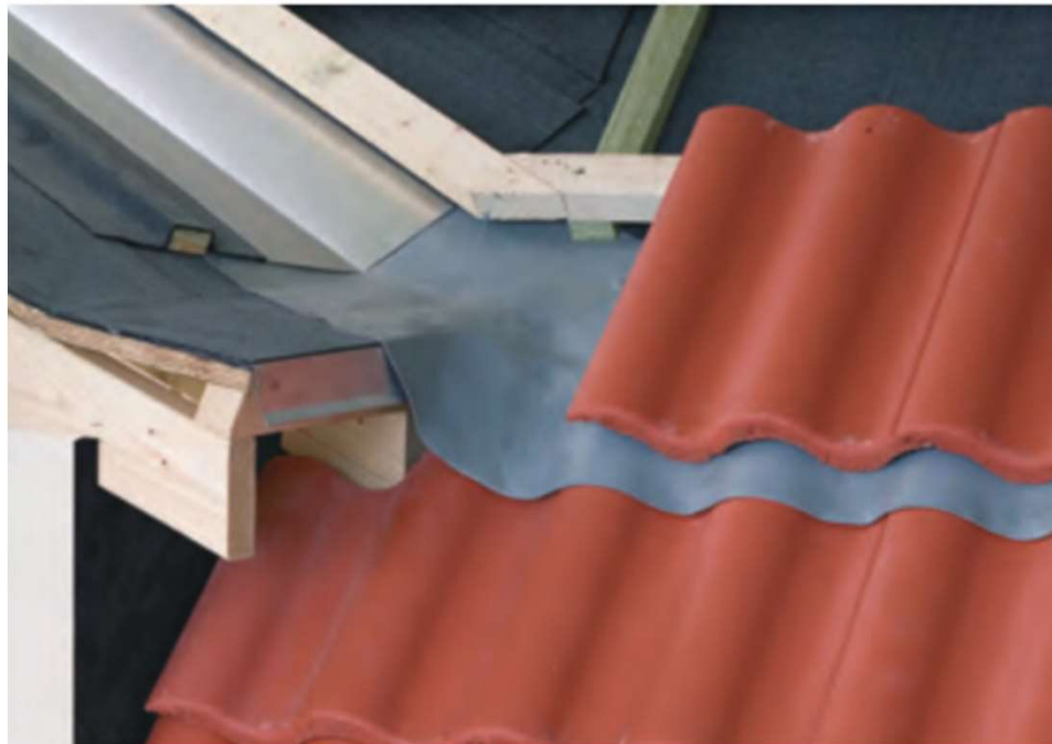
Figur 153 Et fast underlag for skotrenden og for inddekning omkring kvisten nedfældes mellem spær. Skotrenden inddækkes med tagpap samt et formbart inddækningsmateriale ved rendens afslutning.
