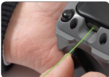
23. Nu aflastes fiberen ved at dreje håndtaget i bunden 180 grader.
