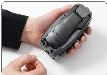
20. Den cleavede fiber føres nu ind i konnektoren i værktøjet.
