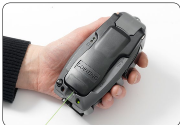
22. Hvis konnekteringen er udført korrekt lyser den grønne lampe.
