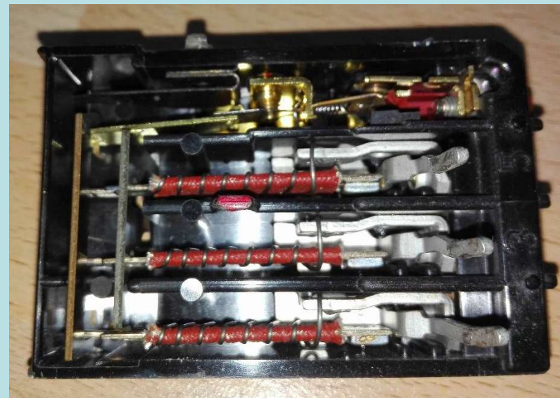
Et kik ind i termorelæet, hvor man kan se de tre bi-metaller med viklinger omkring.
