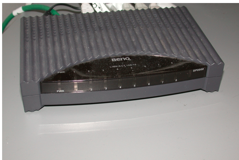
Eksempel på en lille switch (med plads til i alt 8 Pcer)
