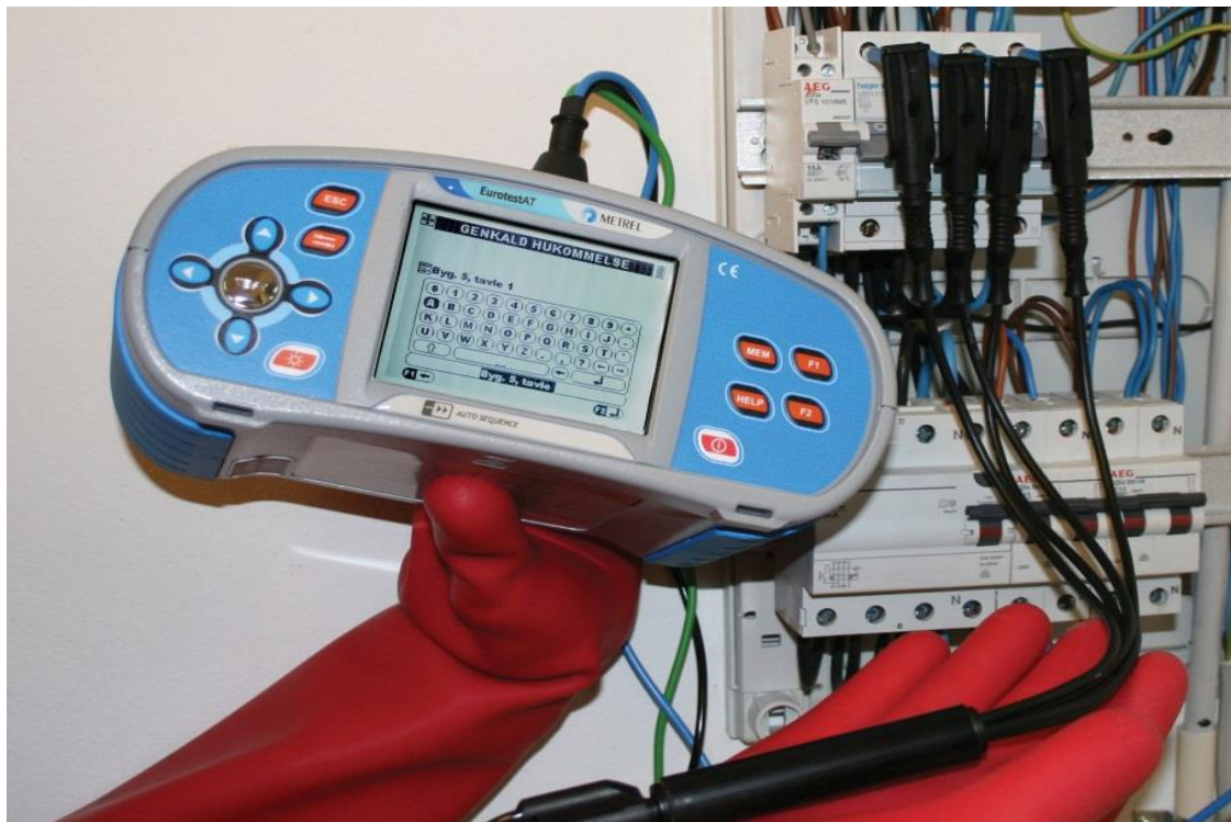
Forbindelse af universal testkabel for almindelig isolationsmodstand (TEST: L-PE)
