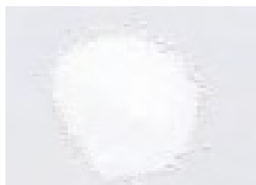
1. 1941 2. USA 3. Polytetrafluorethylen, PTFE 4. Tetrafluorethylen 5. Pulver 6. Termoplast 7. Temperaturbestandige belægninger, tætninger, isolering
