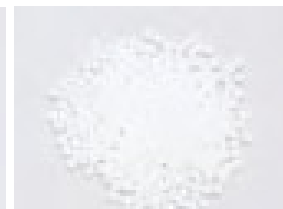
1. 1958 2. USA 3. Acetatplast, POM 4. Formaldehyd 5. Granulat 6. Termoplast 7. Tandhjul, kontor- og husholdningsmaskiner, telefon-, radio-, fon-, TV-apparater
