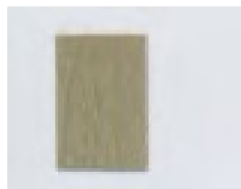
1. 1859 2. Storbritannien 3. Vulkanfiber 4. Cellulosehydrat 5. Halvfabrikata 6. Hærdeplaster 7. Kufferter, pakninger
