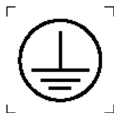
Figur 5 – Symbol IEC 60417-5019: Beskyttelsesjord
