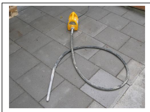
Stavvibrator bruges ved vibrering af beton
