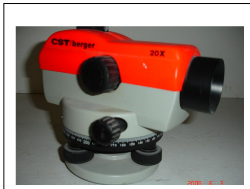
Nivellerings apparat bruges til at måle højder med.
