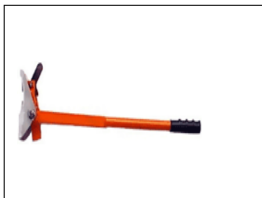
Spæn apparat bruges til at spænde formlåse på forskalling
