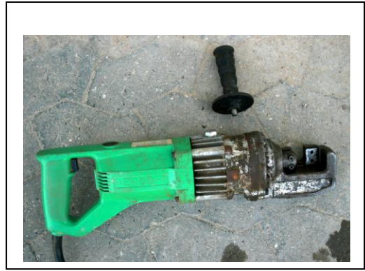
el drevet jernklipper til at klippe armering med
