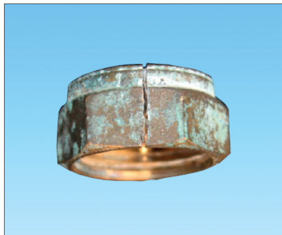
Eksempel på spændingskorrosion i omløber
