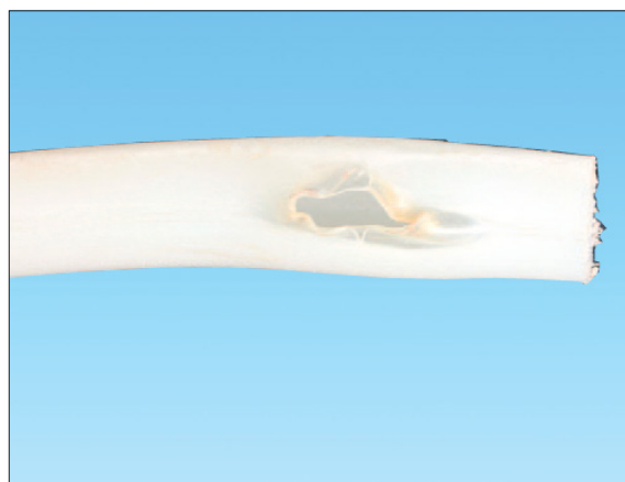
Eksempel på PEX-rør udsat for høj temperatur med lækage til følge
