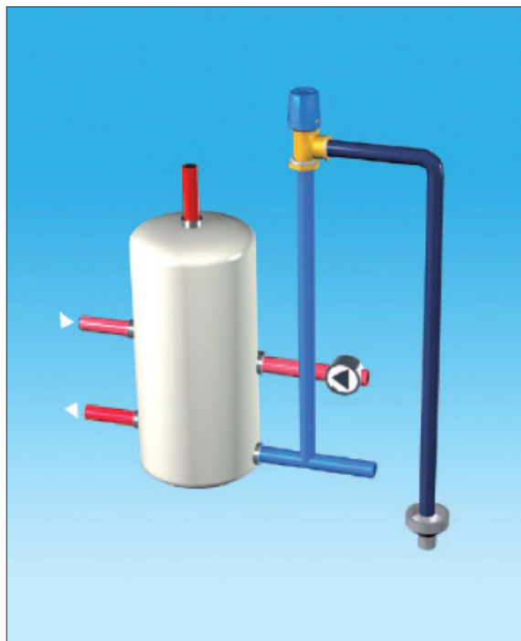
Ved varmtvandsbeholdere over 300 l, skal sikkerhedsventilen sidde fysisk over beholderens top
