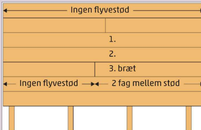
Figur 127 Flyvestød. Endenotede brædder i boliger o.lign. kan samles uden understøtning, dog ikke i første og sidste bræt og højst for hvert tredje bræt i samme fag - aldrig i nabofag.
