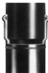
Stikmuffen svejses på rørstykket.
