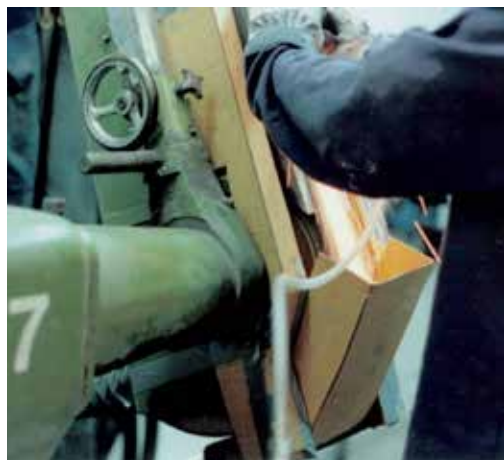
Figur 6.6. Mekanisk opsamling fra en båndsliber.
