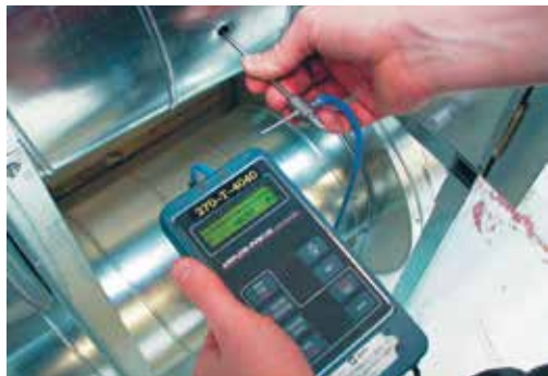
Figur 10.5. Måling af trykdifferens med et pitotrør og et manometer.
